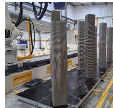
La fabrication digitale au service de l'architecture et de la transition écologique. setec fait construire un nouveau bâtiment pour ses équipes à Vitrolles. Afin d'apporter un design vivant aux poteaux qui rythment les espaces collectifs, nos équipes de conception ont recours à la fabrication additive de béton.
